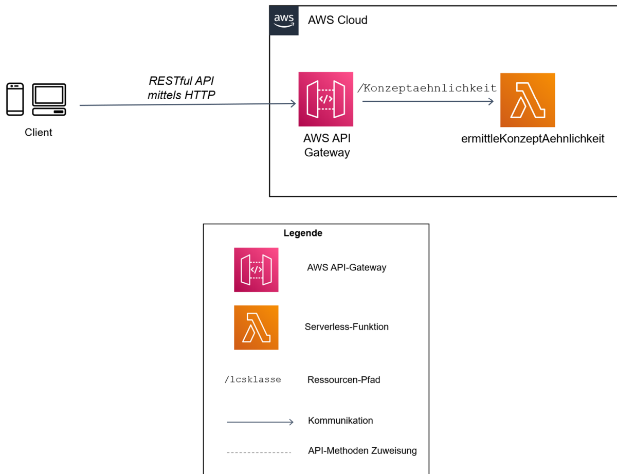
Abbildung 104: Darstellung der Middleware-Komponente des Backends eines ontologiegestützten CBR-Systems
